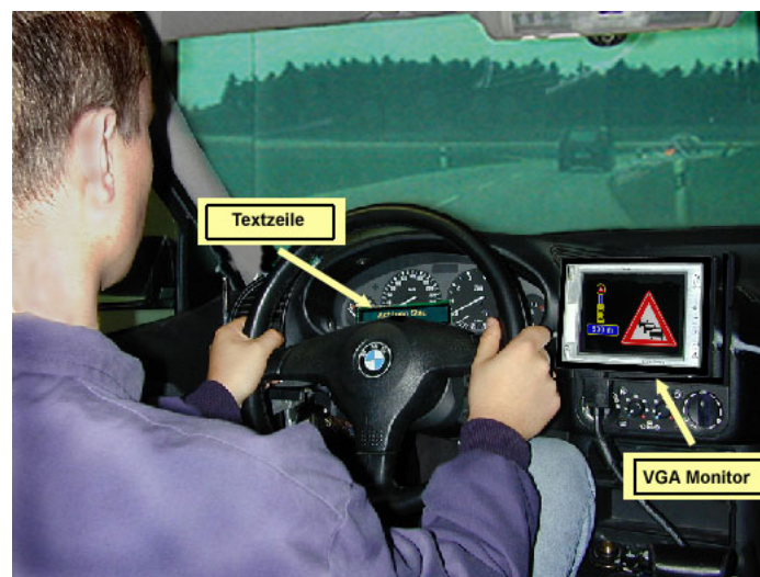
Abbildung 3: Prototypischer Aufbau für BMW im Simulator
