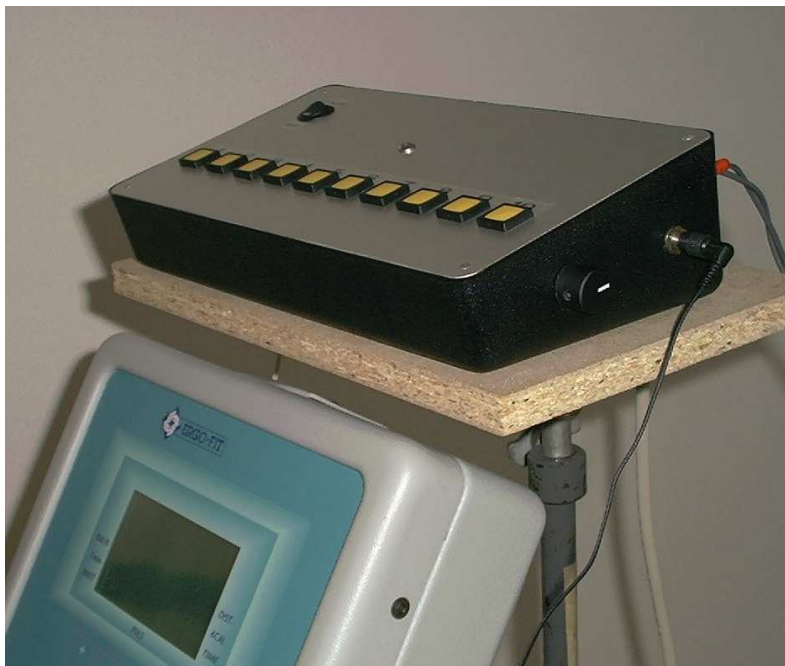
Abbildung 3. Tastenleiste zur Rückmeldung der emotionalen Intensität der Spielsituationen in 10 Stufen (sowie das Display des Ergometers unten links)
