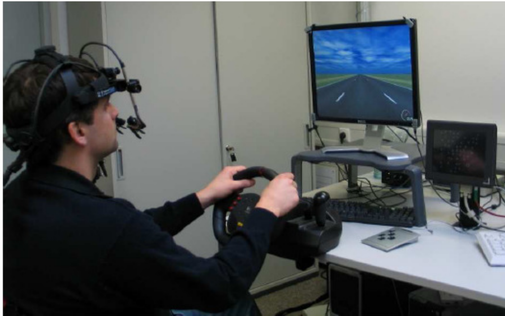
Abbildung 19: Die Abbildung zeigt den allgemeinen experimentellen Aufbau. Zu sehen ist die Versuchsperson mit Eyetracker und den beiden Monitoren für die Haupt- sowie Nebenaufgabe.
