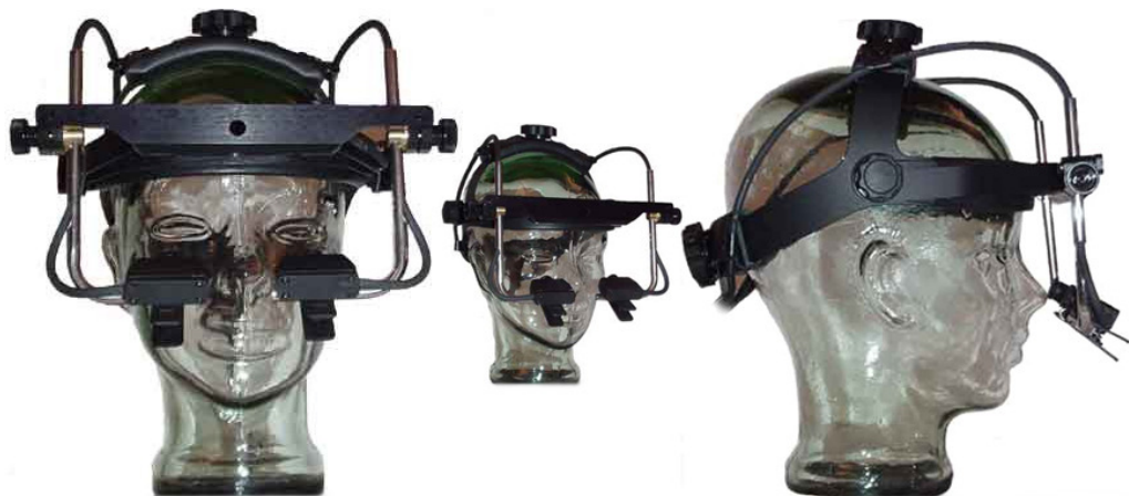
Abbildung 11: Die Abbildung zeigt den für die Bestimmung des ICA verwendeten Eyetracker Eyelink 2
