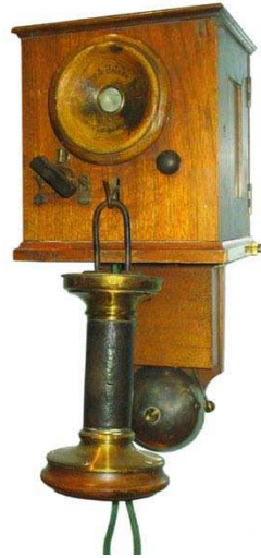
Abb. 1: Siemens & Halske Wandapparat für das erste öffentliche Telefonnetz in Berlin ab 1881.
