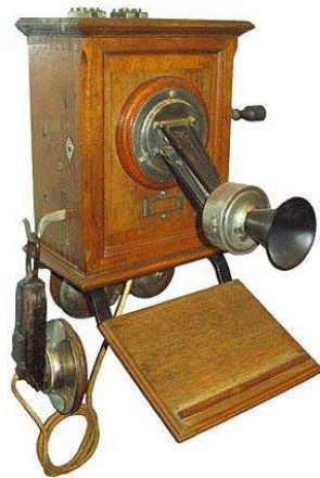
Abb. 7: M03a mit Federmechanismus für die Höhenverstellung des Mikrophons (ab 1907).
